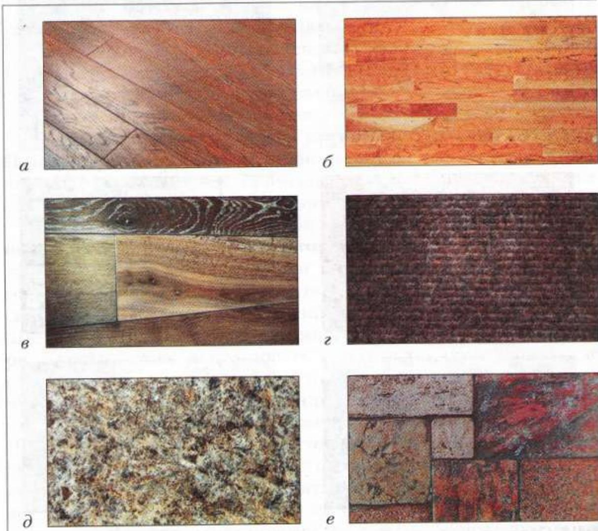
Рис. 4. Напольные покрытия: *а* — ламинат; *б* — паркет; *в* — массивная доска;
